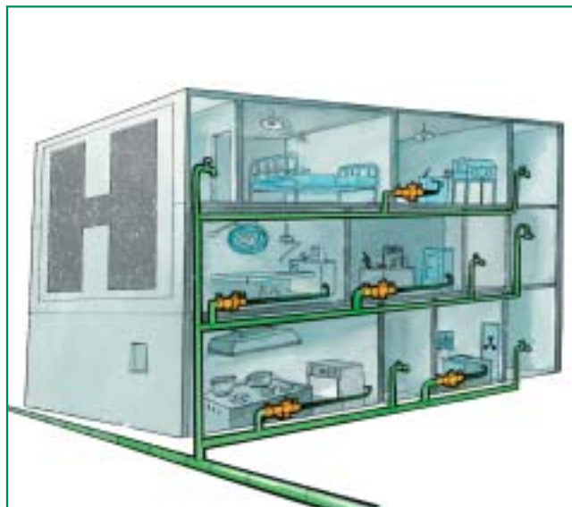
Plaatsing van een terugstroombeveiliging in een ziekenhuis.
